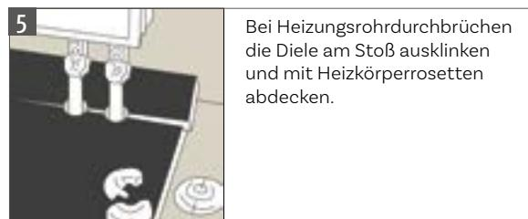
Bei Heizungsrohrdurchbrüchen die Diel am Stoß ausklinken und mit Heizkörperrosetten abdecken.
