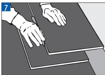
**7** Adaptation de la dernière rangée de lames : Placez exactement la lame suivante à scier sur la rangée de lames posée en dernier. Puis, tracez la coupe longitudinale à l'aide d'une autre lame. Grâce à cette méthode de tracé, il y a suffisamment d'espace par rapport au mur pour emboîter la dernière rangée à l'aide d'un tire-lame.
