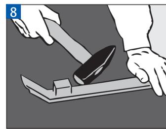
**8** La dernière rangée de lames est rassemblée dans le sens de la longueur avec le tire-lame et rassemblée côté avant avec le bloc de frappe ZIRO.
