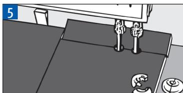
**5** Pour les passages de tuyaux de chauffage, clipsez les lames au niveau du joint et recouvrez avec des rosaces.
