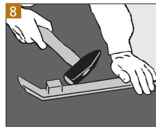
**8** Die letzte Dielenreihe wird mit dem Zugeisen längsseitig und mit dem ZIRO-Schlagklotz stirnseitig zusammengetrieben.
