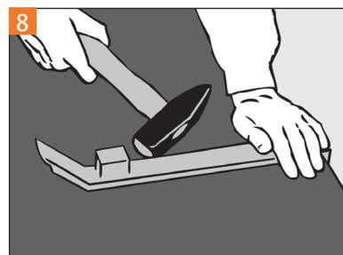
**8** La dernière rangée de lames est rassemblée dans le sens de la longueur avec le tire-lame et rassemblée côté avant avec le bloc de frappe ZIRO.
