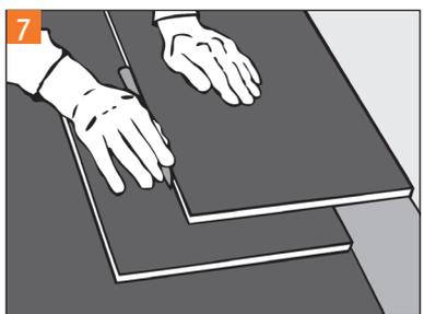
**7** Adaptation de la dernière rangée de lames : Placez exactement la lame suivante à scier sur la rangée de lames posée en dernier. Puis, tracez la coupe longitudinale à l'aide d'une autre lame. Grâce à cette méthode de tracé, il y a suffisamment d'espace par rapport au mur pour emboîter la dernière rangée à l'aide d'un tire-lame.
