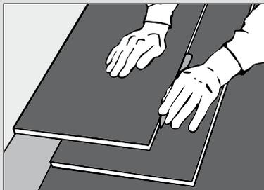
**7** Einpassen der letzten Dielenreihe: Legen Sie exakt auf die zuletzt verlegte Dielenreihe die nachzusägende Dielle. Dann zeichnen Sie mit Hilfe einer weiteren Dielle den Längsschnitt an. Durch diese Art des Anzeichnens bleibt genügend Abstand zur Wand, um die letzte Reihe mittels Zugeisen einzuwinkeln.
