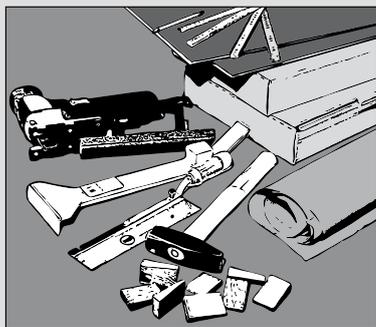
**1** Alles bereit? PE-Folie und Kleband. Als Werkzeug: Zollstock, Bleistift, Stichsäge, Fuchsschwanz, Fäustel, Setzlatte, Zugeisen, ZIRO-Schlagklotz und Abstandskeile.
