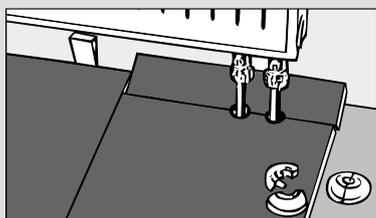
**5** Bei Heizungsrohrdurchbrüchen die Dielle am Stoß ausklinken und mit Heizkörpersetten abdecken.
