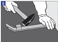
8 Die letzte Dielenreihe wird mit dem Zugeisen längsseitig und mit dem ZIRO-Schlagklotz stirnseitig zusammengetrieben.
