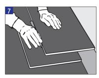
7 Einpassen der letzten Dielenreihe: Legen Sie exakt auf die zuletzt verlegte Dielenreihe die nachzusägende Diele. Dann zeichnen Sie mit Hilfe einer weiteren Diele den Längsschnitt an. Durch diese Art des Anzeichnens bleibt genügend Abstand zur Wand, um die letzte Reihe mittels Zugeisen einzuwinkeln.
